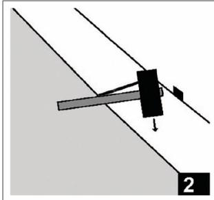
Danach klicken Sie die nächste Diele am Kopfende an, bis diese durch leichtes Klopfen mit einem Gummihammer in der Verbindung verriegelt und eben auf dem Boden aufliegt. Dies wiederholen Sie, bis Sie am Ende der ersten Reihe gelangt sind. Wichtig ist, dass die erste Reihe plan liegt.
